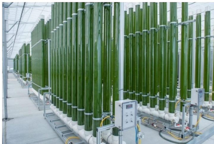
FIGURA 3.3 - SISTEMA FECHADO (TIPO TUBULAR) PARA CULTIVO DE MICROALGAS
