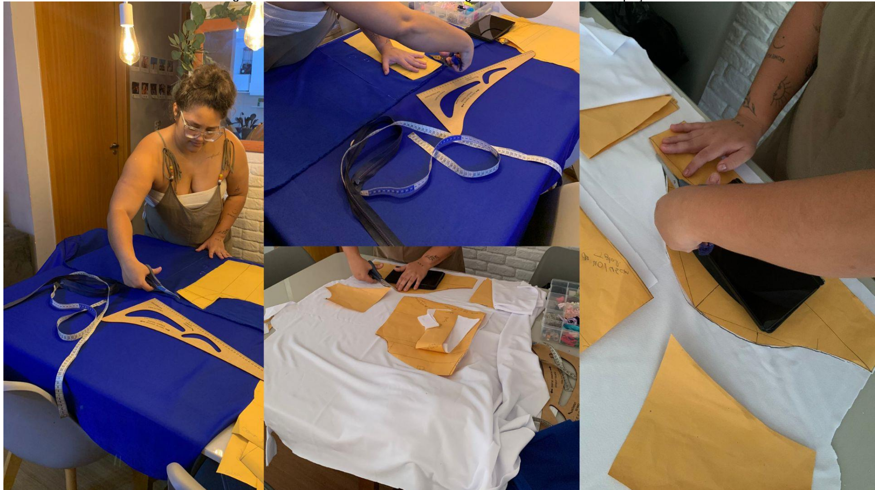
Figura 44: Processo de encaixe da modelagem elaborada e corte das peças
