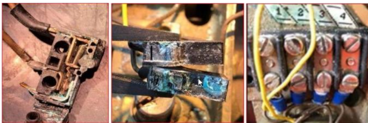
FIGURA 14 – FOTOS DOS TERMINAIS ELÉTRICOS E COMPONENTES INTERNOS DA VÁLVULA DIRECIONAL E MICRO SWITCH.
