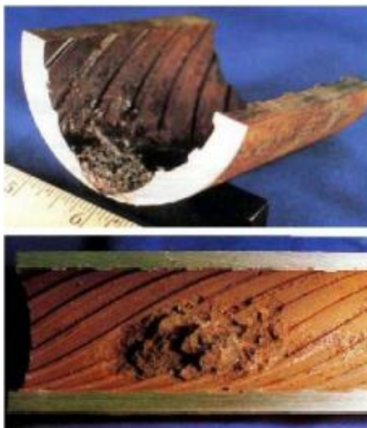
Figura 8 – Tubo de uma caldeira que sofreu ataque cáustico
