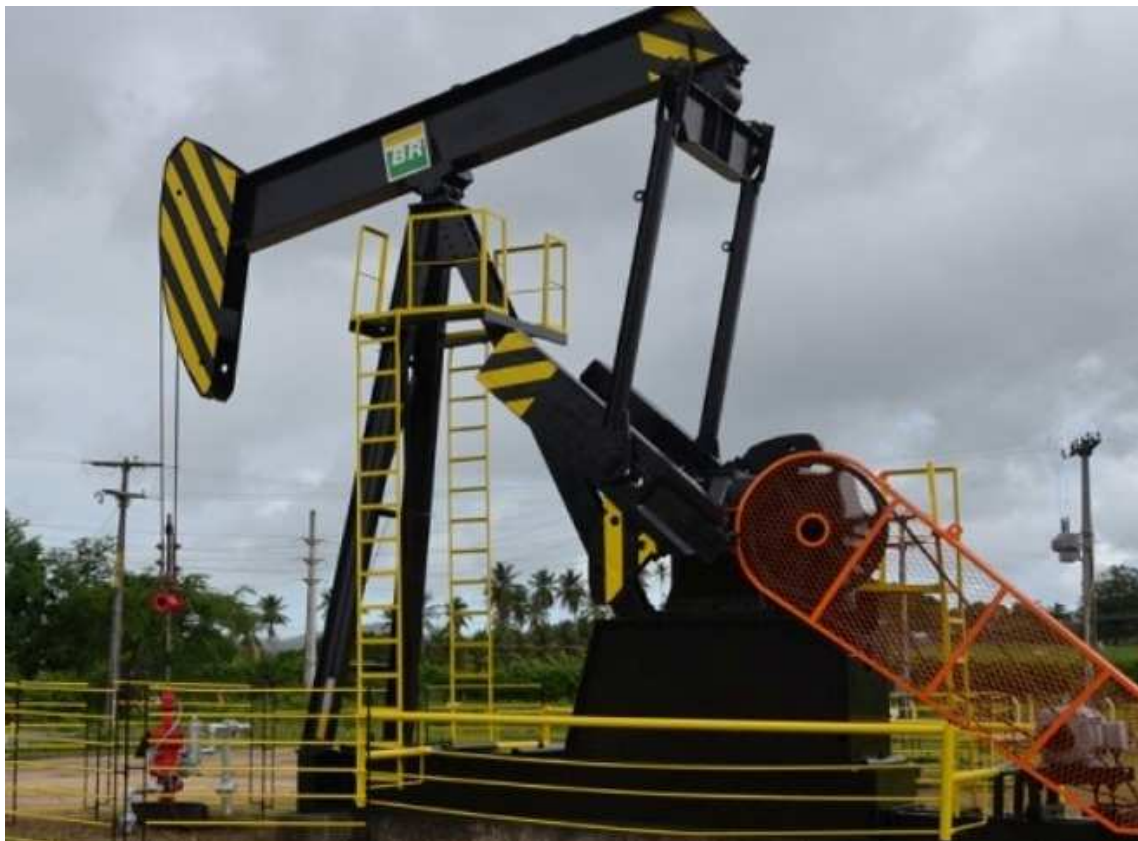
Figura 1. Poço de petróleo equipado com o método de elevação bombeio mecânico.
