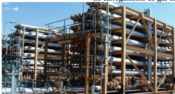
Figura 2.20 – (a) Skids com módulos de membranas do tipo UOP Separex™ e (b) elemento utilizado no carregamento de gás de um módulo de membrana.
