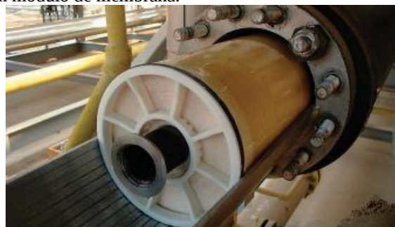
Figura 2.20 – (a) Skids com módulos de membranas do tipo UOP Separex™ e (b) elemento utilizado no carregamento de gás de um módulo de membrana.
