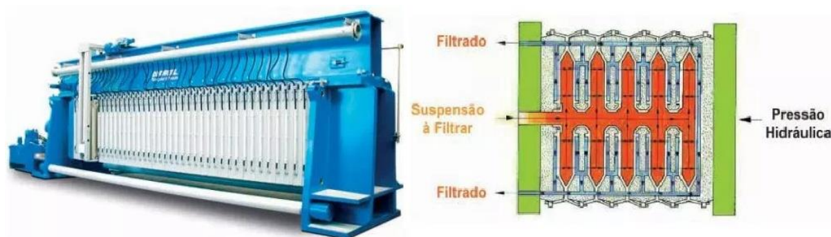
Figura 2 – Filtro prensa: visão externa e interna.
