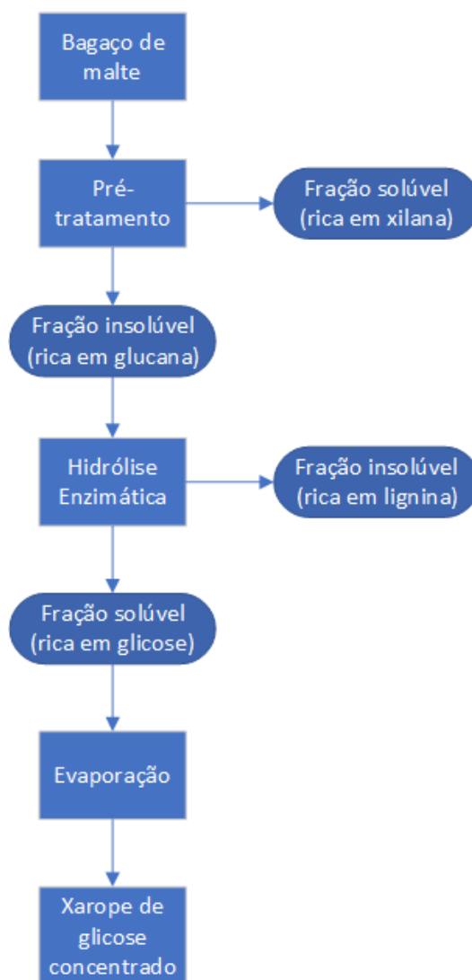
Figura 9 – Fluxograma da etapa de hidrólise enzimática.
