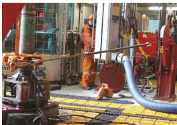
Figura 5: Quebra de torque em broca com atuação direta do assistente, na mesa rotativa.
