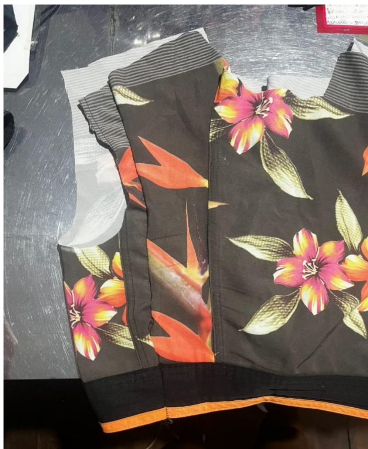
Figura 51: Foto do desalinhamento da parte de trás
