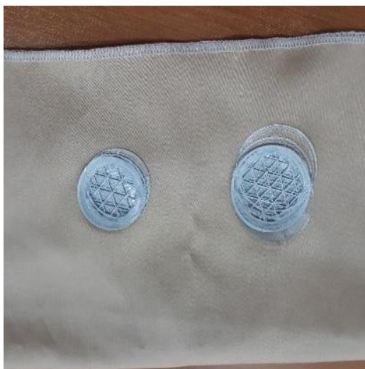
Figura 46. Foto dos erros de impressão.
