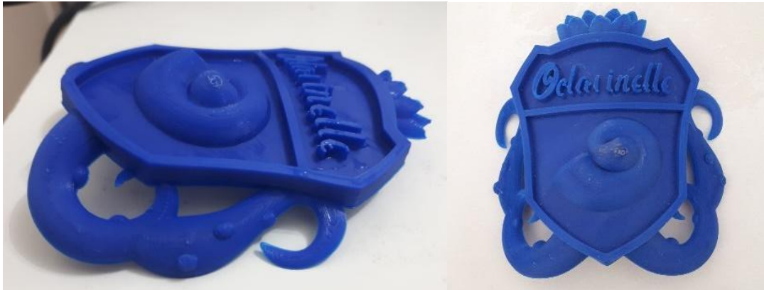
Figura 69. Brasão distorcido com água quente.
