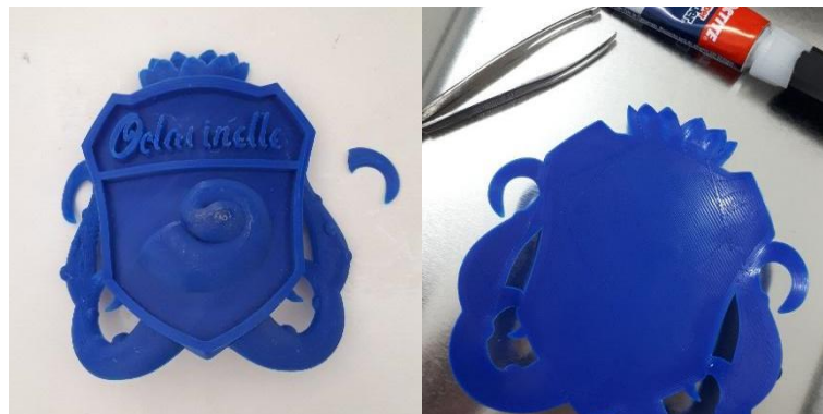
Figura 70. Brasão com a parte do tentáculo quebrada (1) e tentáculo colado (2).
