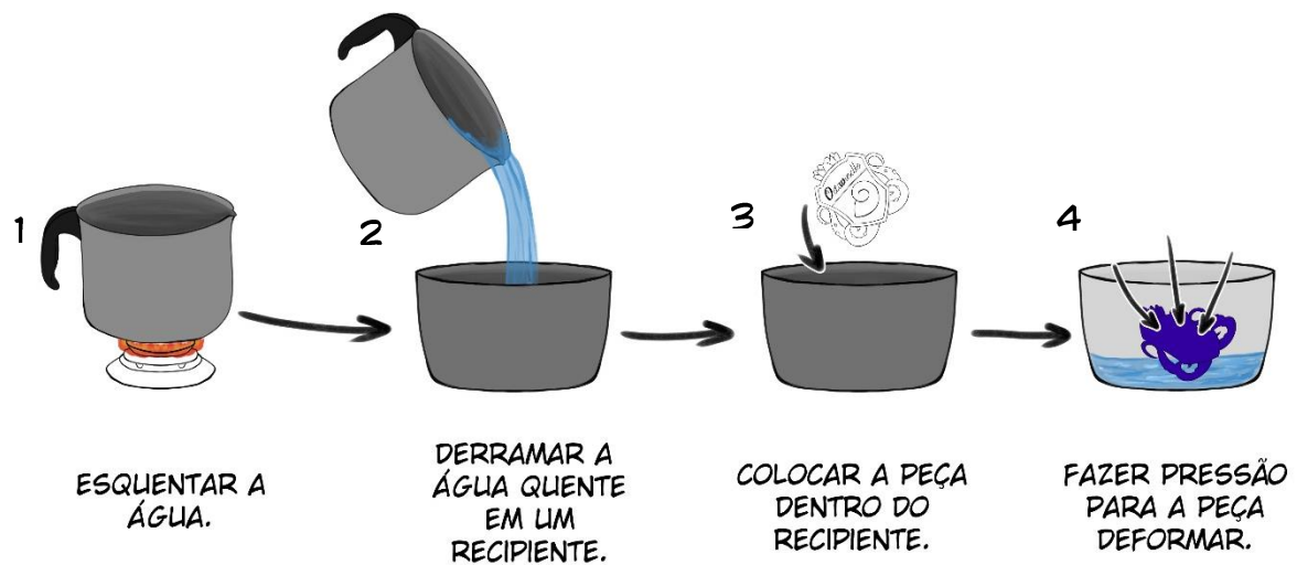
Figura 25. Passo-a-passo de como o experimento seria realizado.
