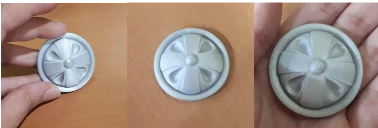
Figura 41. Fotos do botão impresso utilizando a tecnologia de impressão 3D.
