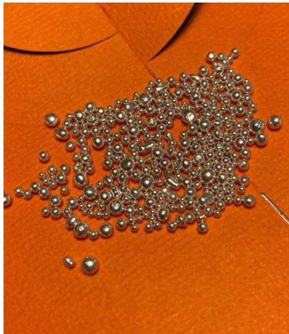
Figura 14 – Esferas de prata 1000 (pura) utilizadas para confecção da liga de prata 925.
