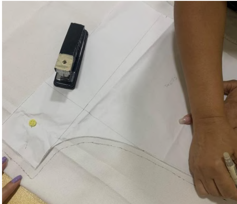
Imagem 101: Construindo o molde do short
