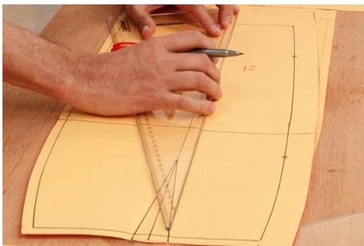
Figura 39: Como é feita a modelagem plana.
