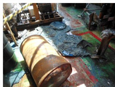
Tonéis e bombonas distorcidos após o incêndio
