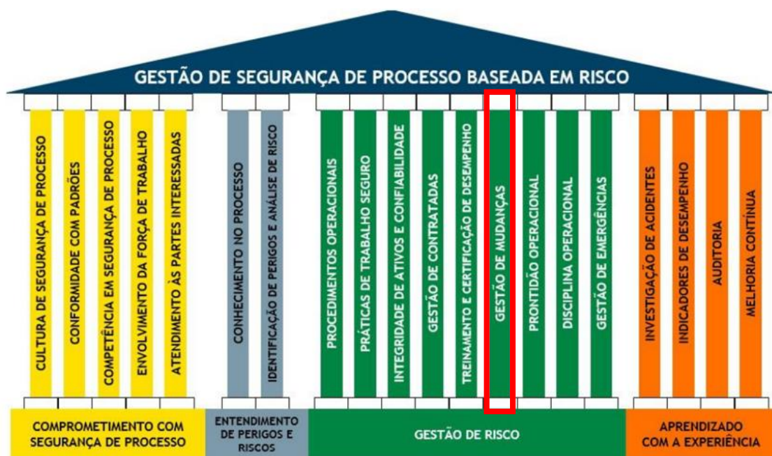
Figura 2: Sistema de gerenciamento de segurança de processo
