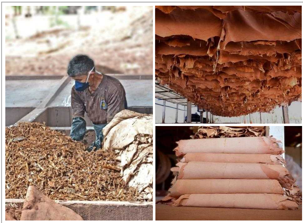
Ilustração 7. Processo de curtimento com casca de angico.
