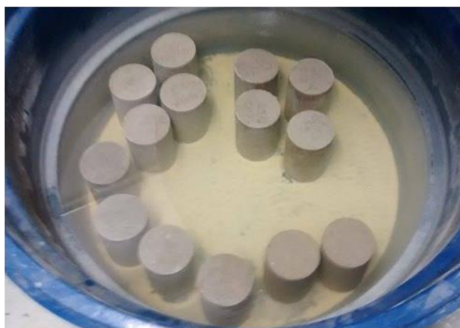
Figura 2 — Processo de cura úmida por 28 dias
