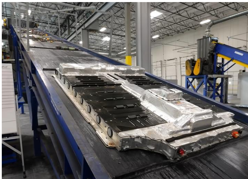
Figura 5 – Bateria de lítio de um carro elétrico usada entrando no processo de extração de seus componentes.
