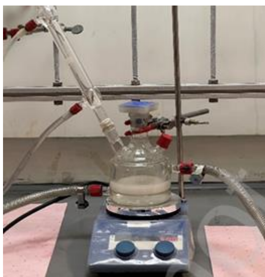
Figura 7 – Reator de vidro revestido utilizado em bancada para precipitação homogênea dos compostos de lítio recuperado.
