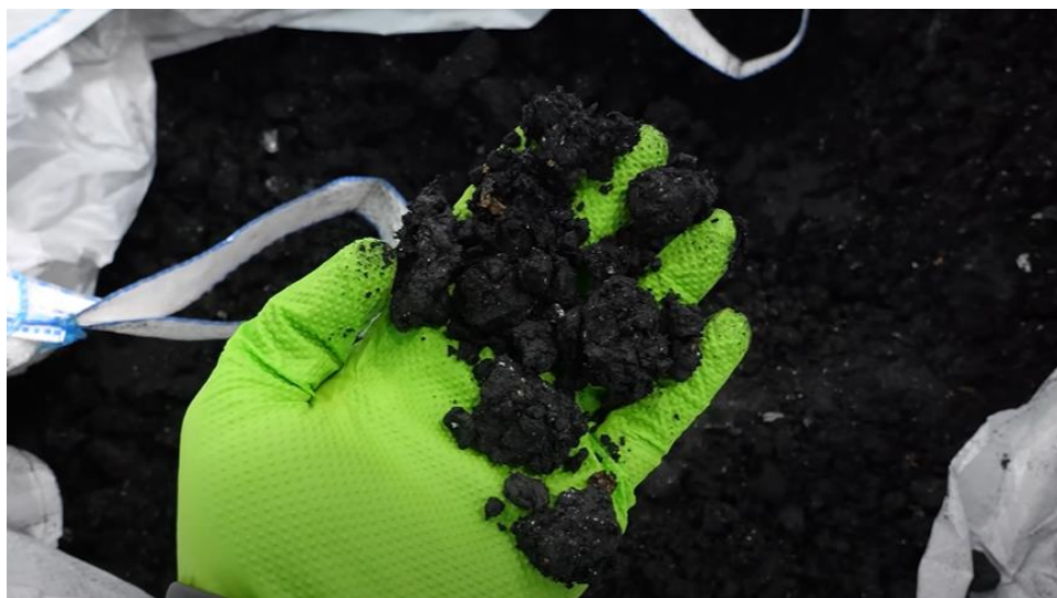
Figura 6 – Massa Negra recuperada do processo de extração empregado pela empresa Li-Cycle.
