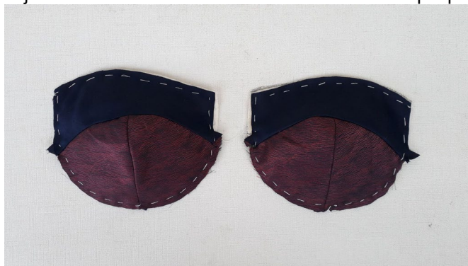
Figura 67: bojo elaborado no tecido e na manta unidos com pesponto manual.
