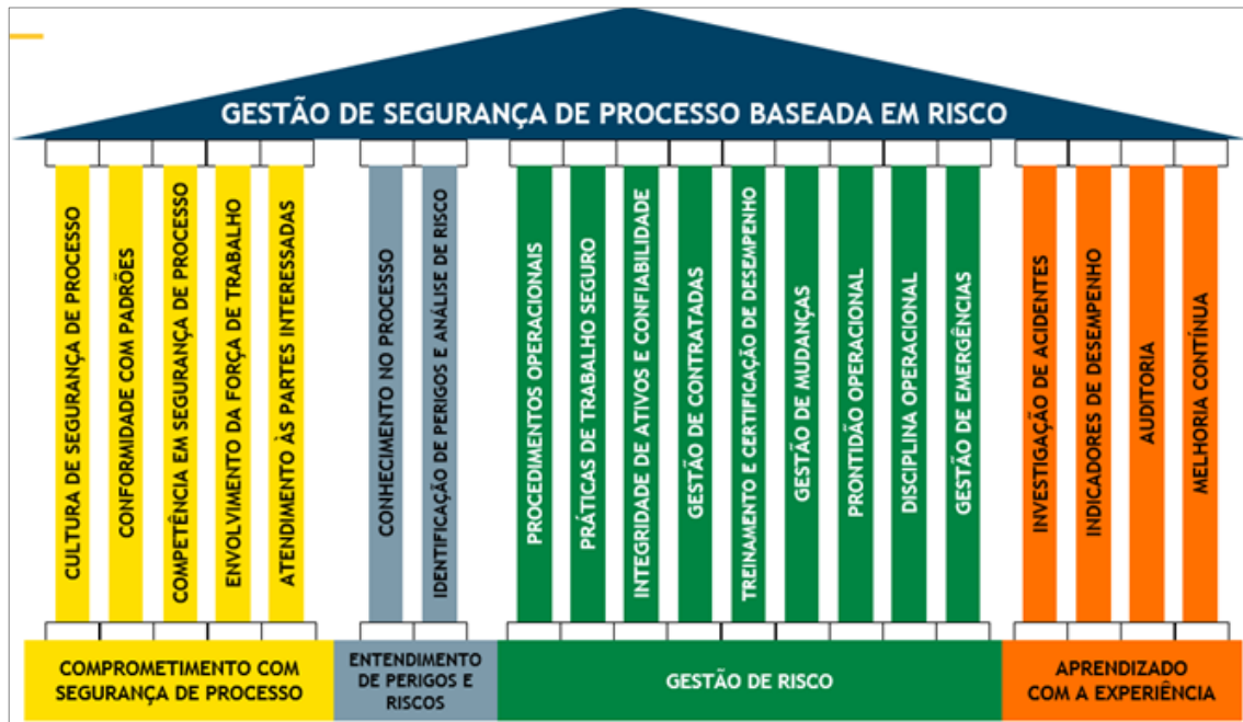
Figura 2: Pilares e elementos associados que constituem o Sistema de Gestão de Segurança de Processos Baseado em Risco
