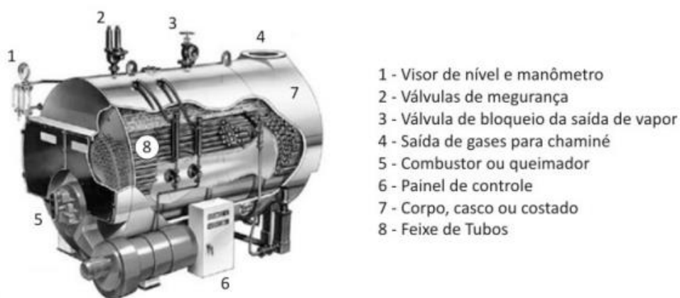
Figura 15 – Componentes básicos para caldeira flamotubular
