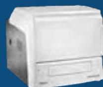
**VARIOSKAN:** O equipamento vem equipado com diferentes tecnologias de medição em tempo real, incluindo absorção e intensidade de fluorescência com luminescência para 96 amostras simultâneas.
